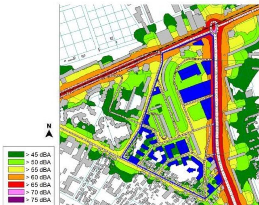
Figure 11: Cartographie sonore de l'état futur avec projet à quatre mètres au-dessus du sol - période 6 h-22 h
