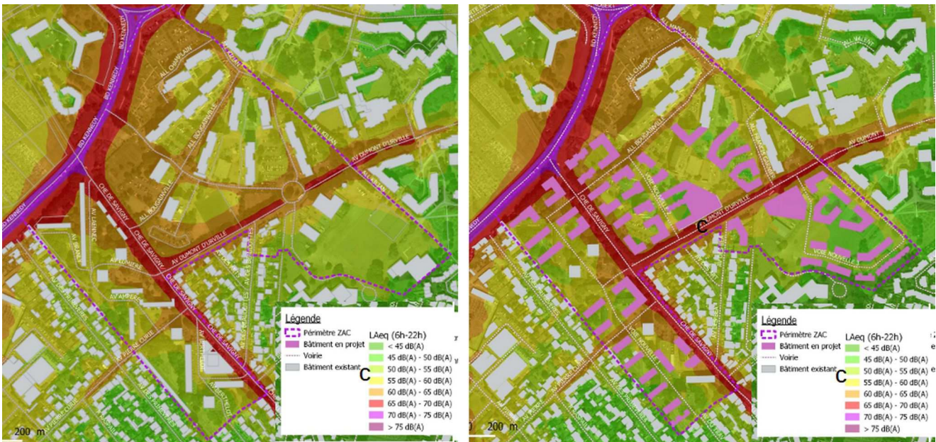
Figure 6: ambiance sonore de jour (LAeq) - scénario de référence et projet (A.04, p. 63/65)
