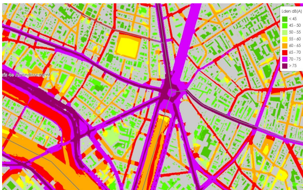
Figure 13 : nuisances sonores (tous bruits confondus) autour de la place de la Bastille et dans les rues adjacentes (source Bruitparif)
