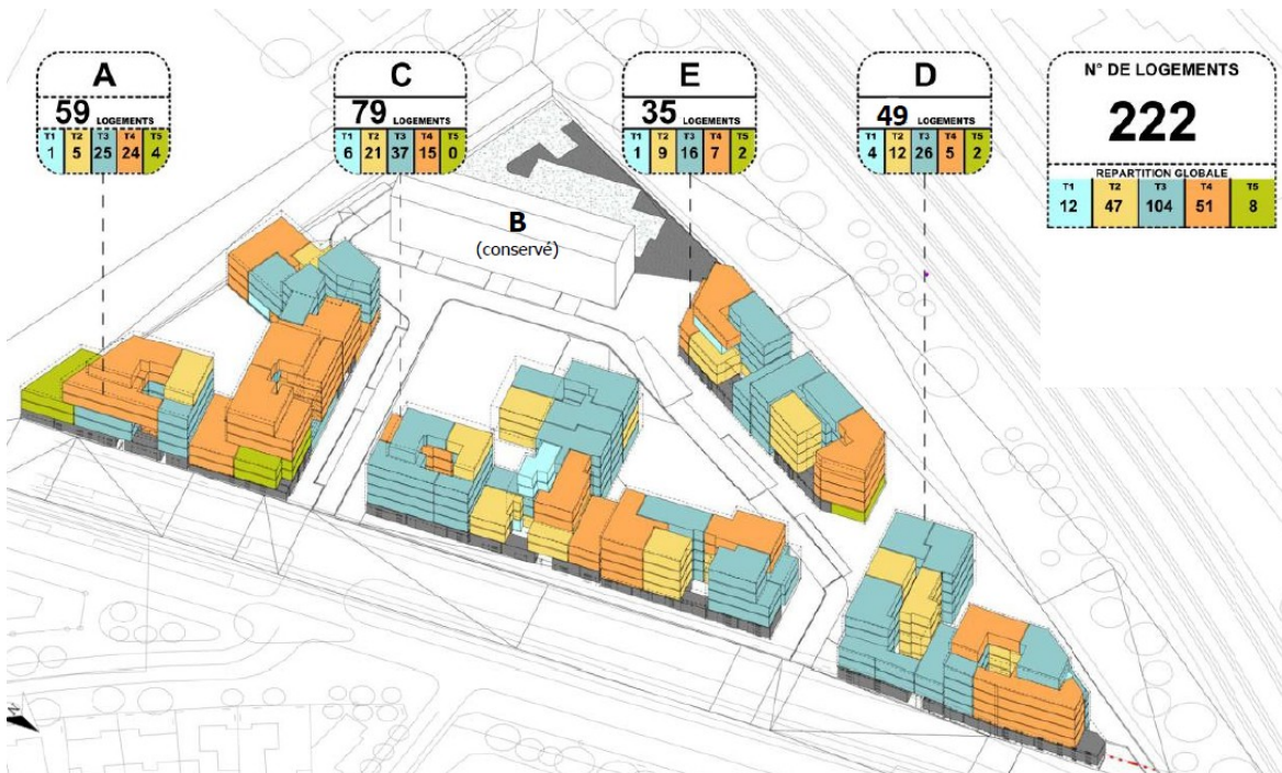
Illustration 3: Plan guide des nouveaux bâtiments, détaillant le nombre et la typologie des logements (Étude d'impact, p. 21)
