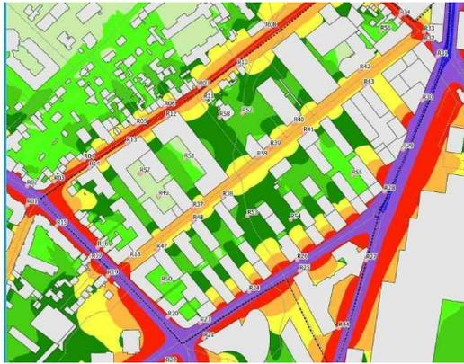
Figure 9: Résultat des modélisations acoustiques en situation projetée prenant en compte les évolutions de trafic routier : certaines façades seront exposées à des niveaux sonores supérieurs à 65 dB Laeq (EI partie 5, p. 67). (L'échelle des niveaux sonores n'est pas la même que sur la Figure 7.)
