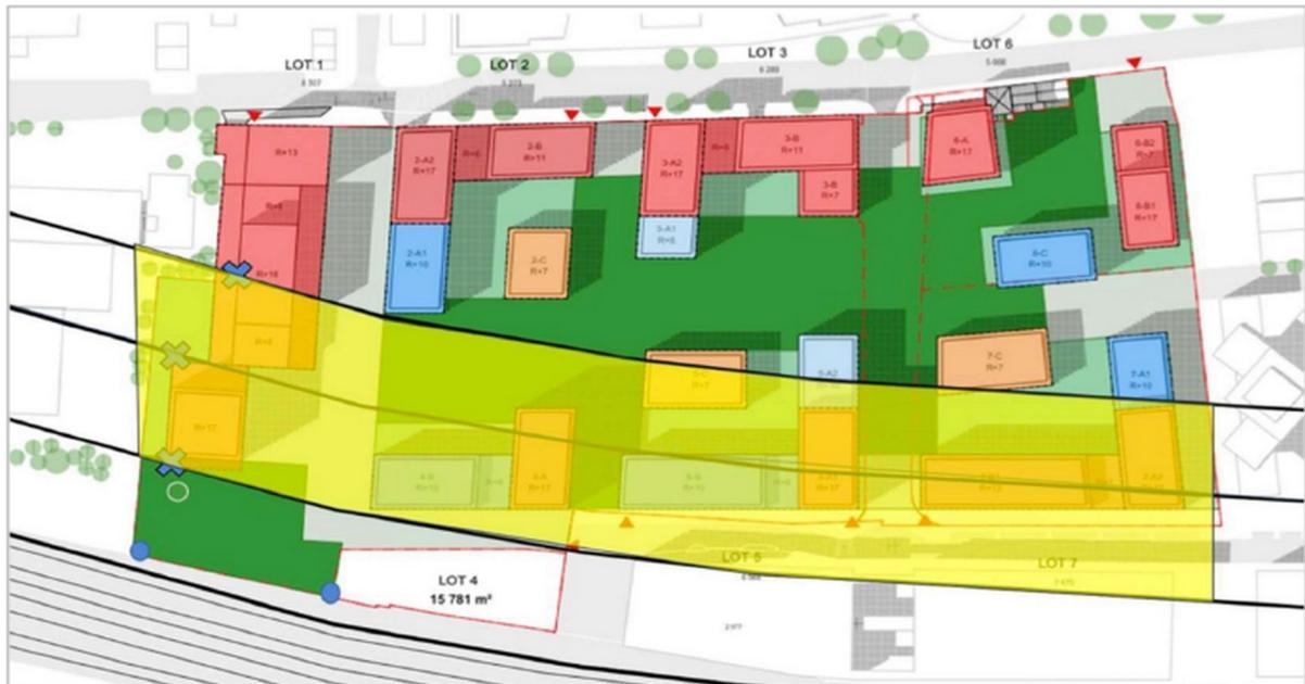
Figure 5 : bâtiments à désolidariser vis-à-vis des vibrations issues des voies ferrées, dans une bande de cent mètres (en jaune), source : étude d'impact, p. 468.
