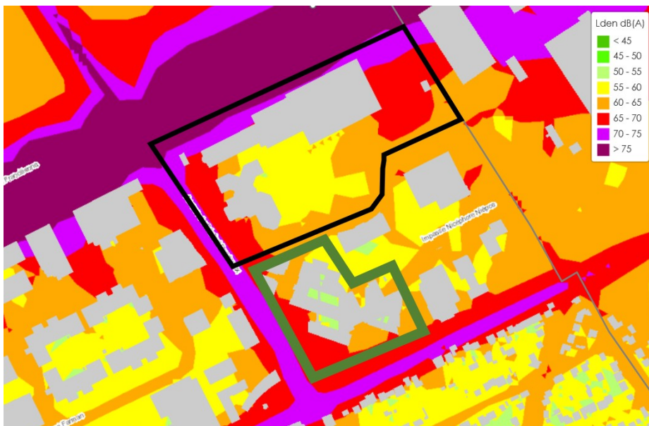
Figure 9: implantation du projet (en noir) sur une carte de Bruitparif présentant les niveaux de bruit le jour. En vert apparaît l'emprise du lycée (source MRAe et Bruiparif)
