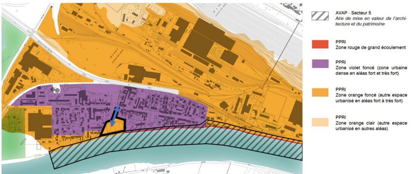
Figure 6: zonages du PPRI avec détournage en noir du site du projet et en bleu l'esquisse de la passerelle envisagée dans l'OAP (source dossier OAP et compléments MRAe)
