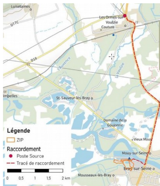
Figure 5: Solution de raccordement externe au poste source d'Ormes envisagé par le maître d'ouvrage (source : EIE, p.189)
