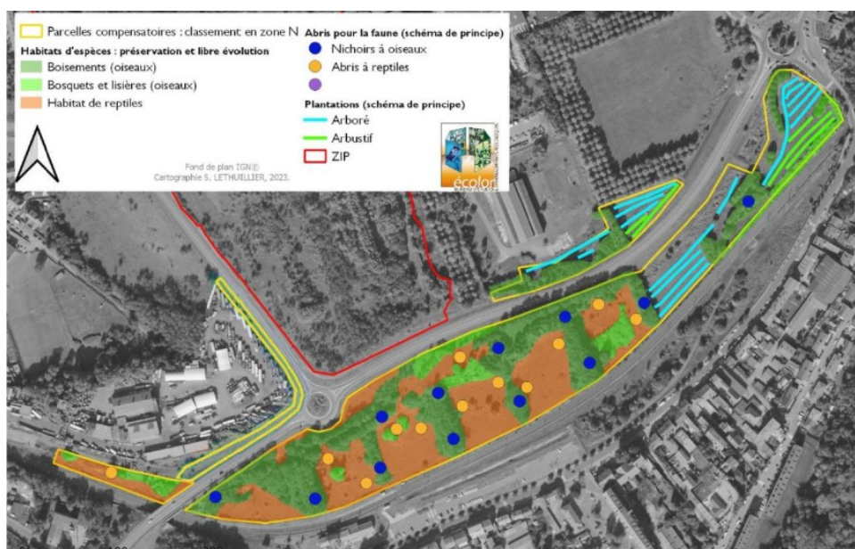
Figure 5: Cartographie des mesures compensatoires du projet de centrale photovoltaïque. Source : dossier de centrale du pétitionnaire AKUO.
