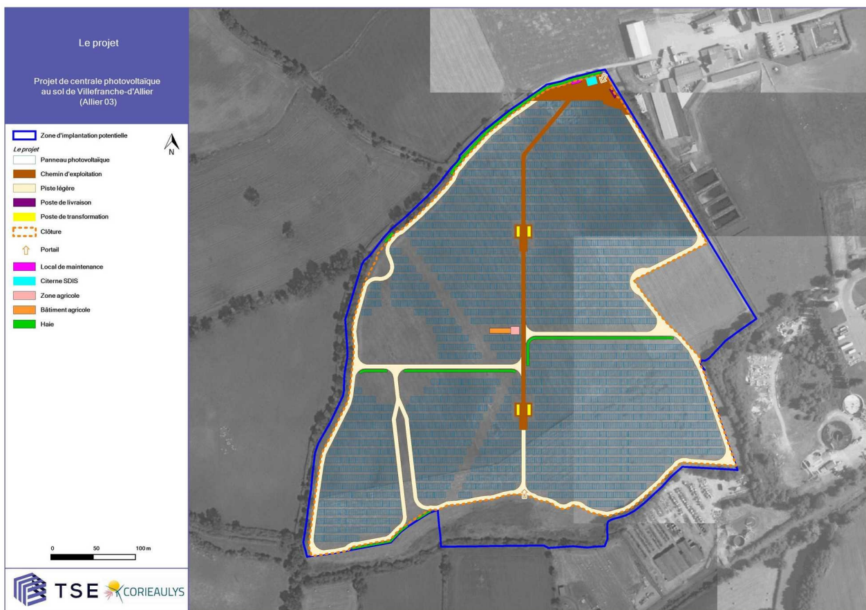
Figure 2 : Plan d'implantation du projet de 17,3 ha d'emprise clôturée (source : Résumé de l'étude d'impact).
