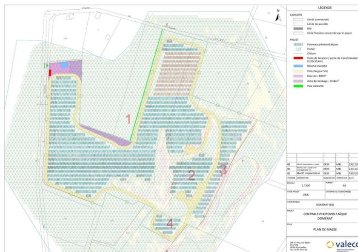
Figure 2: Plan d'implantation du projet d'environ 6,8 ha (source : permis de construire)
