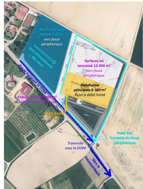
Figure 4: Schéma d'évacuation des eaux pluviales
