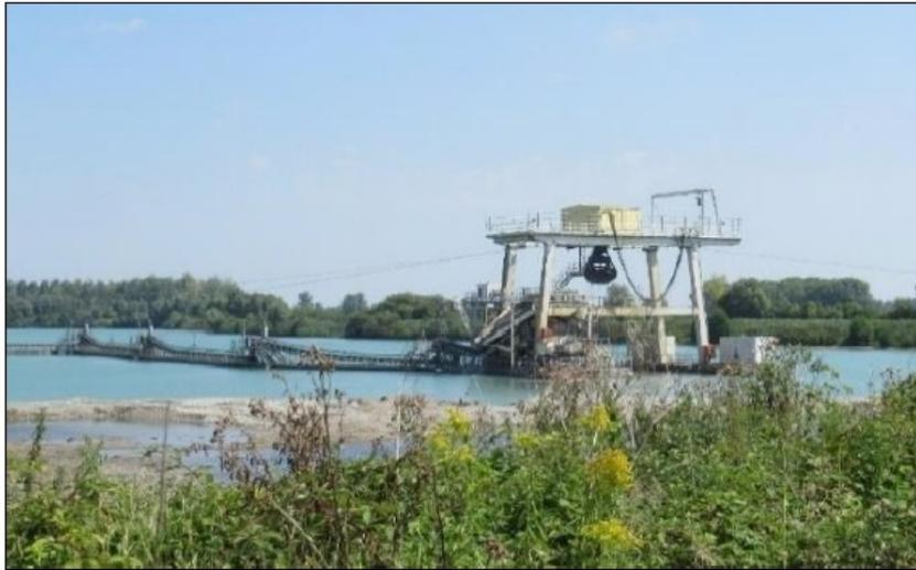
**Figure 3 – drague flottante à grappin**
