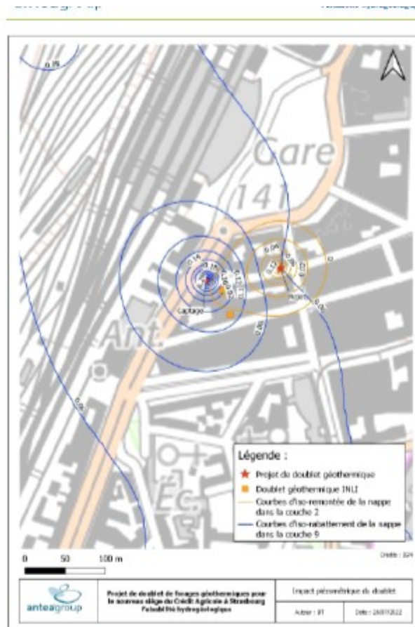
Figure 38 : Remontée et rabattement calculés au niveau du doublet au débit maximal de 200 m 3 /h (dans la partie supérieure et dans la partie inférieure de la nappe)
