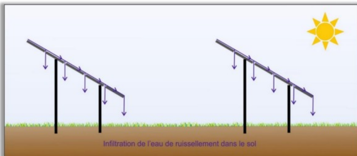
Figure 4: Effet des panneaux solaire sur l'écoulement des eaux pluviales Source : Sciences Environnement
