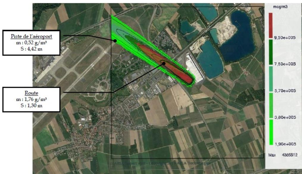
**Figure 8 – représentation des fumées du panache d'incendie de la cellule n°2 du bâtiment**
