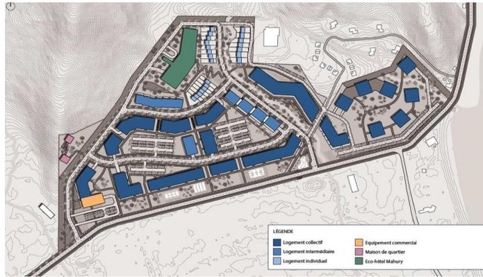
La voie de circulation principale est décrite comme occupant une emprise de 16 m de large, soit 6,5 m de route, 2 m de trottoirs de part et d'autre, 2 m de noues recueillant les eaux pluviales de chaque côté. Le différentiel de 1,5 m n'est pas expliqué, peut-être occupé par des espaces plantés étant donné l'affichage environnemental du projet.
