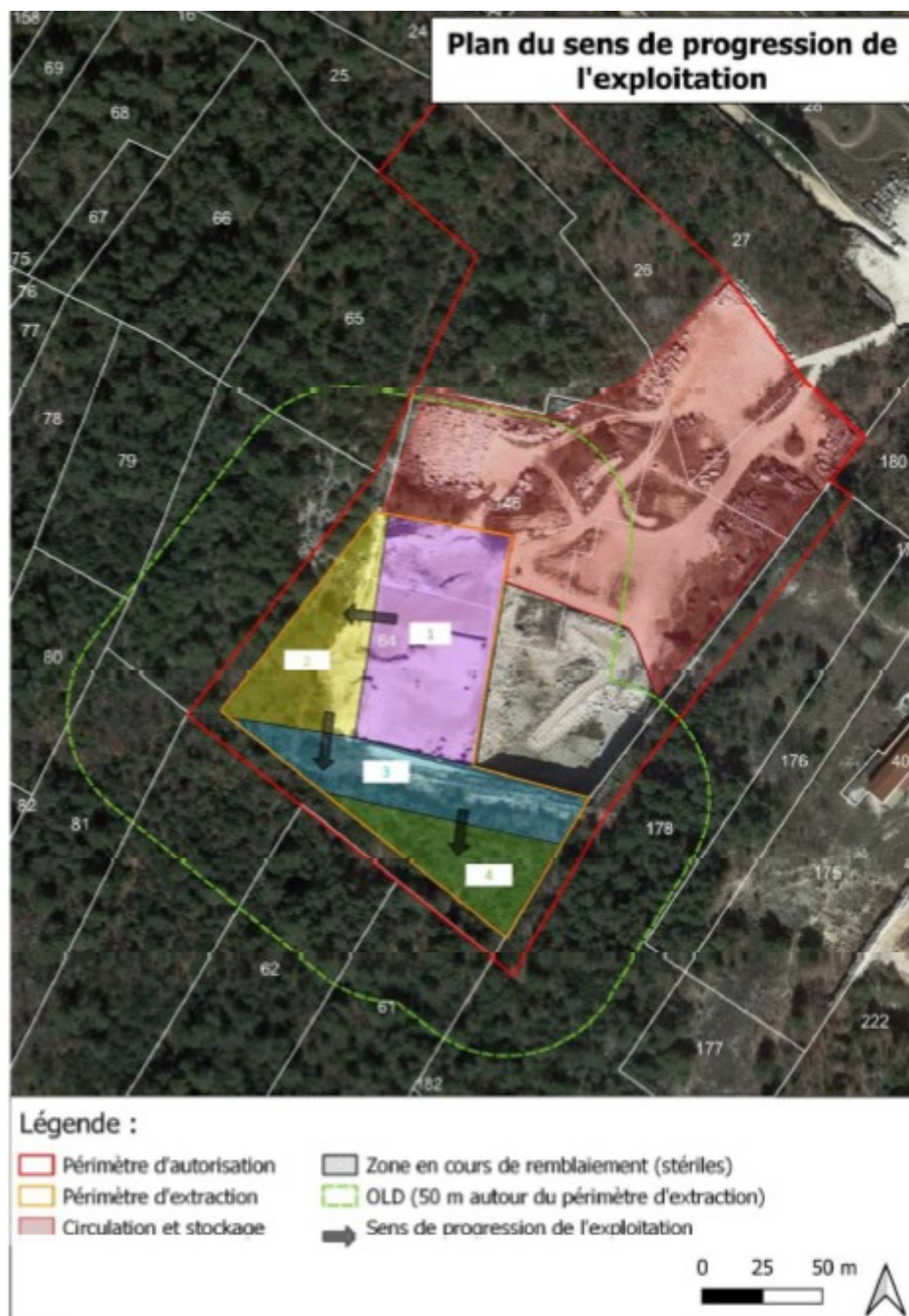
Figure 3: sens de progression de l'exploitation (source : étude d'impact)
