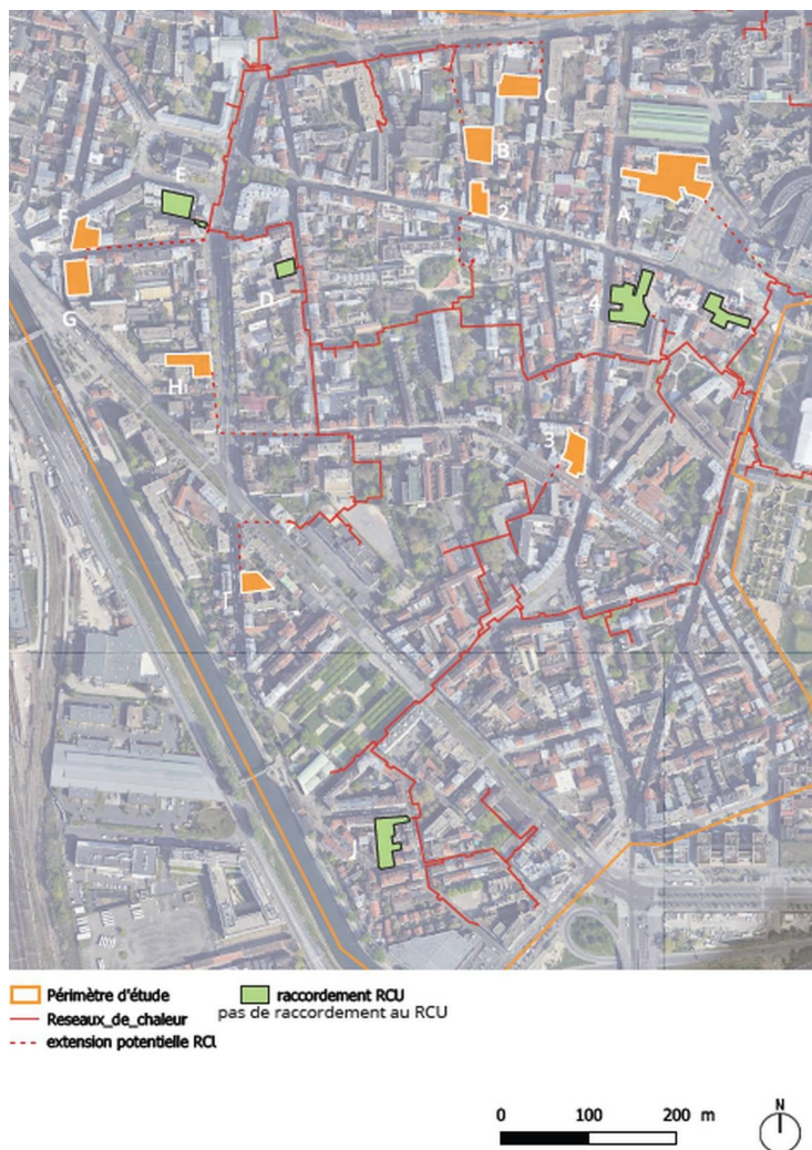
Figure 10: Réseau de chaleur et localisation des opérations potentiellement raccordées en vert (étude EnR&R, p. 22)
