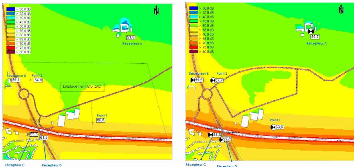
Figure 15: Ambiance sonore à l'état initial à gauche, et à l'état projet en 2030 à droite (EI 307/410)
