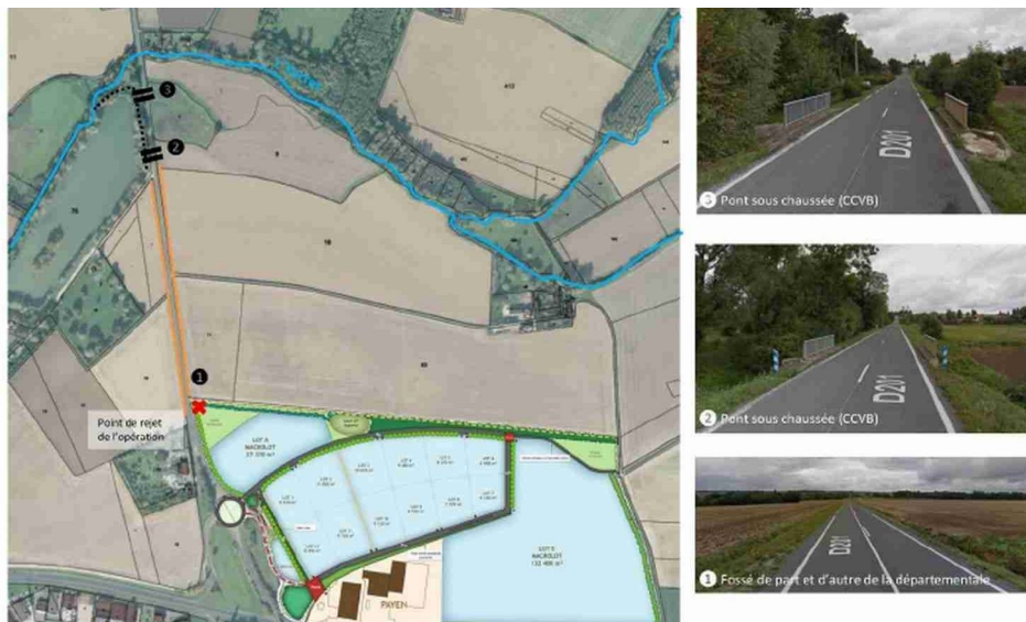
Figure 7: Cheminement des eaux pluviales (DP, p. 58)
