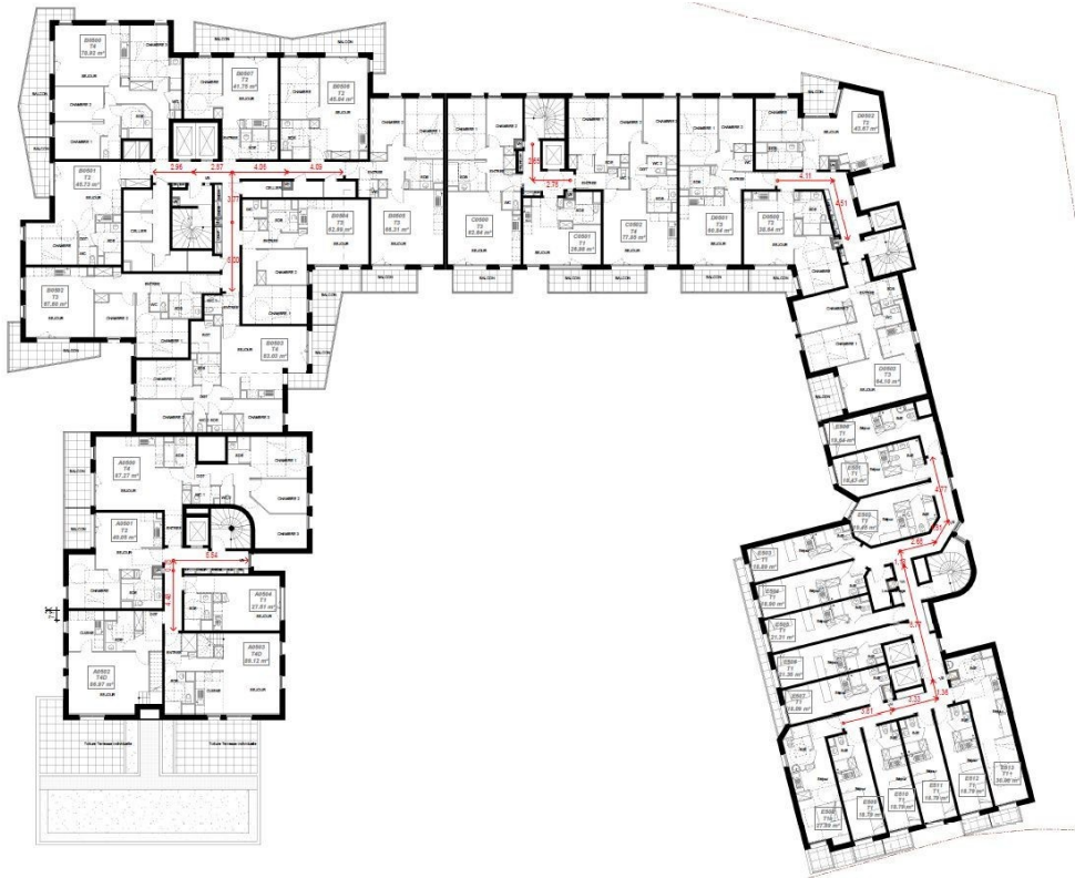
Figure 9 : Plan de masse du niveau R+5. On constate que cet étage courant comprend des pièces de vie (chambres et salons) directement exposées sur l'avenue du Général de Gaulle et la rue Saint-Simon. (source : p.4 578_PC-AN01 Carnet de plans de niveaux)
