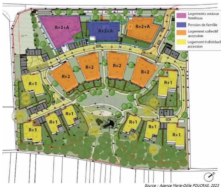
Figure 4 : Plan masse du projet, volumétries maximales (EIE, p.30)
