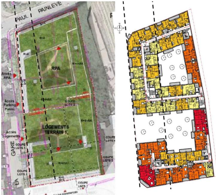
Figure 3: Zone 1, projet précédent à gauche et projet actuel à droite. L'élargissement de la bande bâtie à l'ouest (délimitée par les lignes en pontillés) a été élargie, réduisant la taille des cours qui assurent l'ensoleillement et les vues des logements orientés vers le cœur d'îlot (source : étude d'impact p. 12 et permis de construire, plan du R+2 et R+3)
