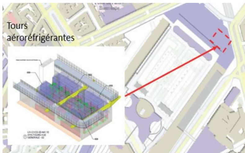
Figure 4 : Localisation prévue des tours aéro-réfrigérantes en toiture du PRD Montparnasse (source : note de saisine, p. 13)
