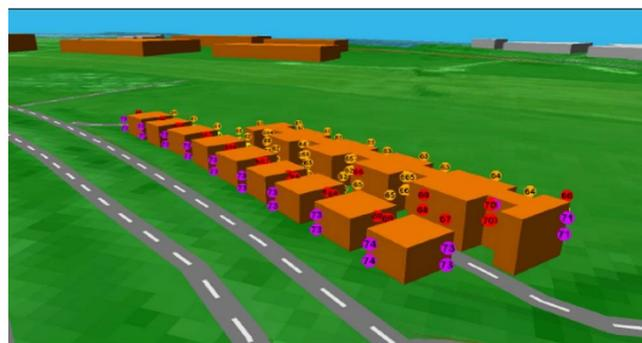
Figure 10 : Niveaux sonores modélisés en 3-D en façade des bâtiments d'habitation - Les couleurs renvoient à la légende des figures 8 et 9 (source : EI, p. 199)
