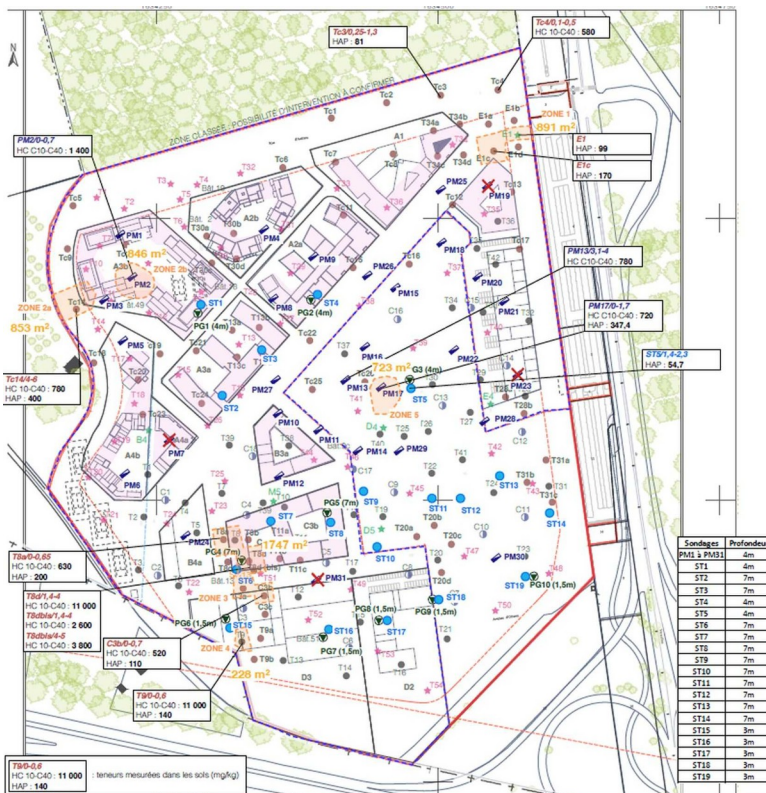
Figure 10: Cartographie des impacts dans les sols (source : annexe 11, plan de gestion de la pollution des sols, p. 344)
