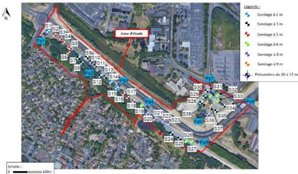
Figure 16 : Localisation des sondages réalisés et des piézomètres posés dans le cadre de la campagne d'investigations (source : volet 3, p.135)
