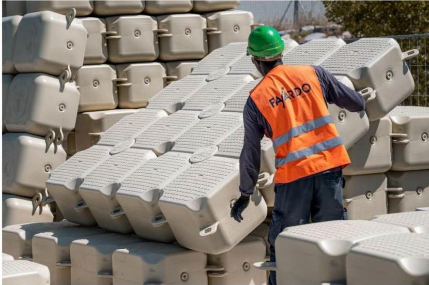
Figure 5: Exemple de flotteur pour centrale flottante (source : étude d'impact)
