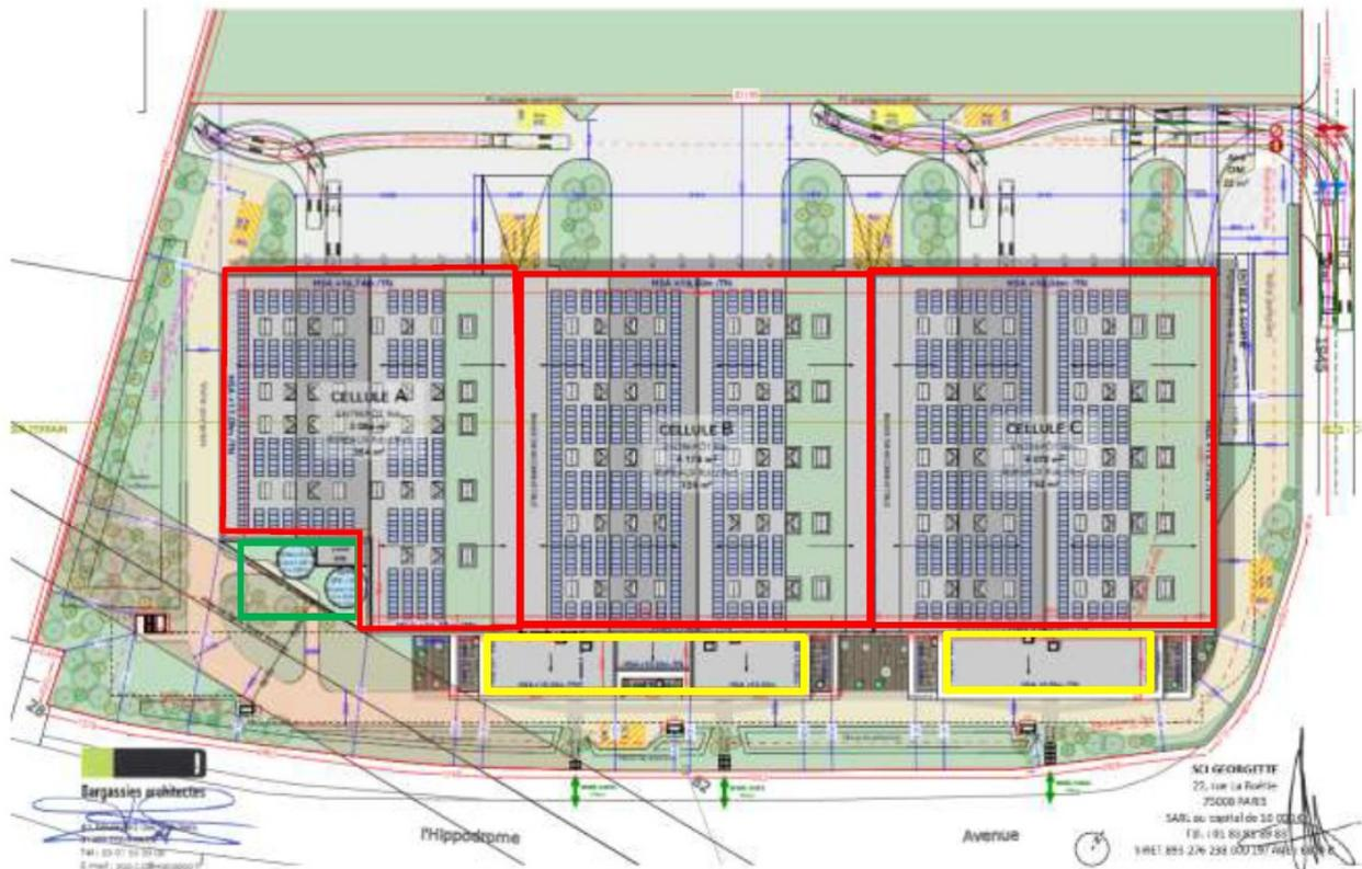
Figure 2 : Plan masse du projet, avec en rouge les cellules de stockage, en jaune les bureaux et en vert les locaux techniques (Source : dossier)
