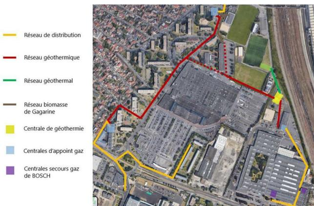
Figure 7 - Fonctionnement du réseau et emplacement de la centrale de géothermie et des centrales gaz d'appoint et de secours - Source : Étude d'impact p.50
