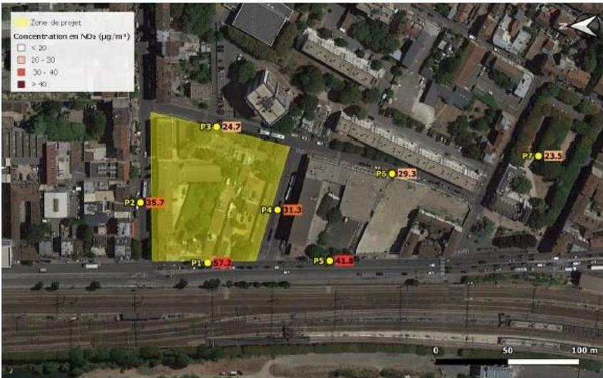
Figure 8 : Positionnement des points de mesure et résultats de la concentration en NO<sub>2</sub> (source : étude d'impact, p. 107). Le nord est à gauche.
