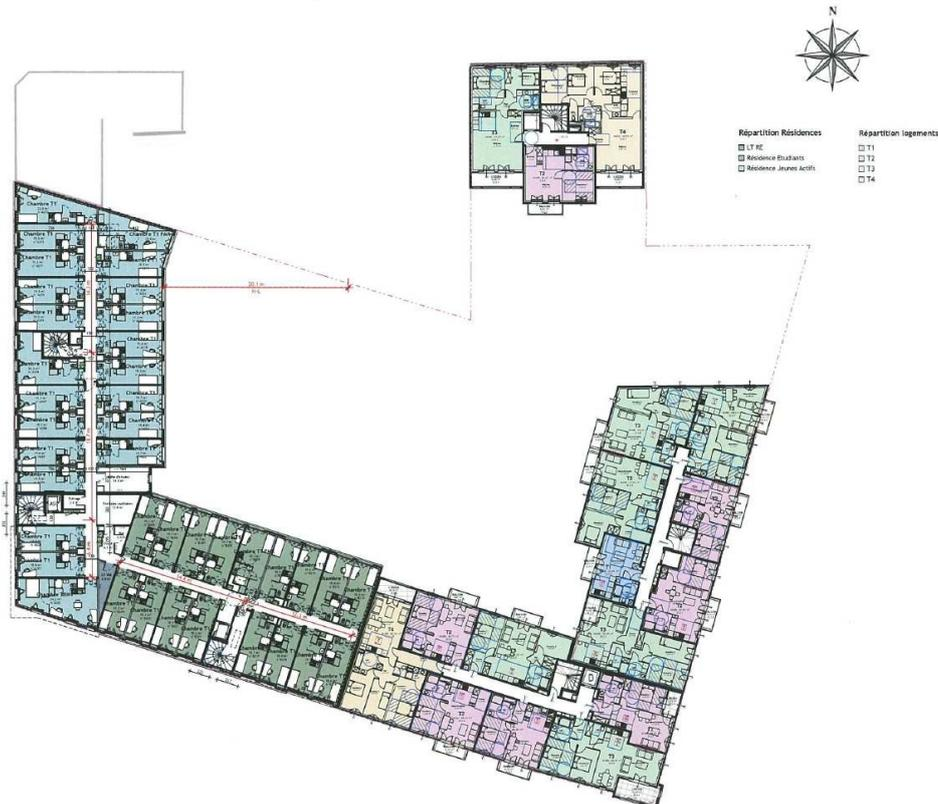
Figure 10 : Cet étage courant (plan R+2) comprend principalement des logements mono-orientés, y compris à l'ouest sur la rue de Paris, dont plus de la moitié de ceux de la résidence étudiante. Il n'apparaît que quatre logements traversants, dont les deux au nord où toutes les chambres donnent sur l'avenue Carnot (source : permis de construire, ANX03, p. 3)
