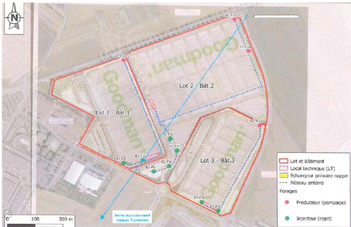
**Figure 4: Emplacement des puits de pompage et d'injection des quatre triplets géothermiques (Montage à partir des figures des pages 34 de l'étude d'impact)**
