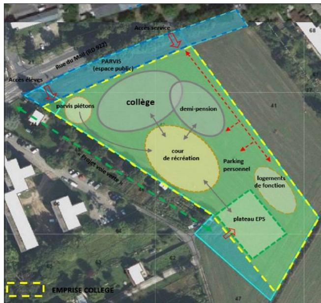
Figure 4 : schéma d'organisation du projet de collège et de ses abords (source : additif au RP p. 25)
