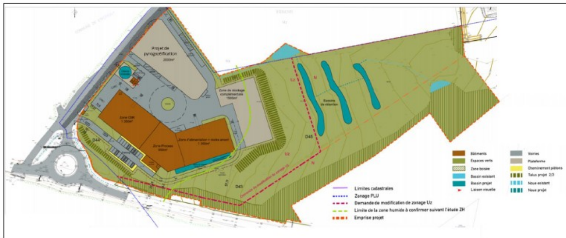
Illustration 7: Projet d'implantation du centre de tri et de préparation de CSR et du projet de pyrogazéification- source dossier
