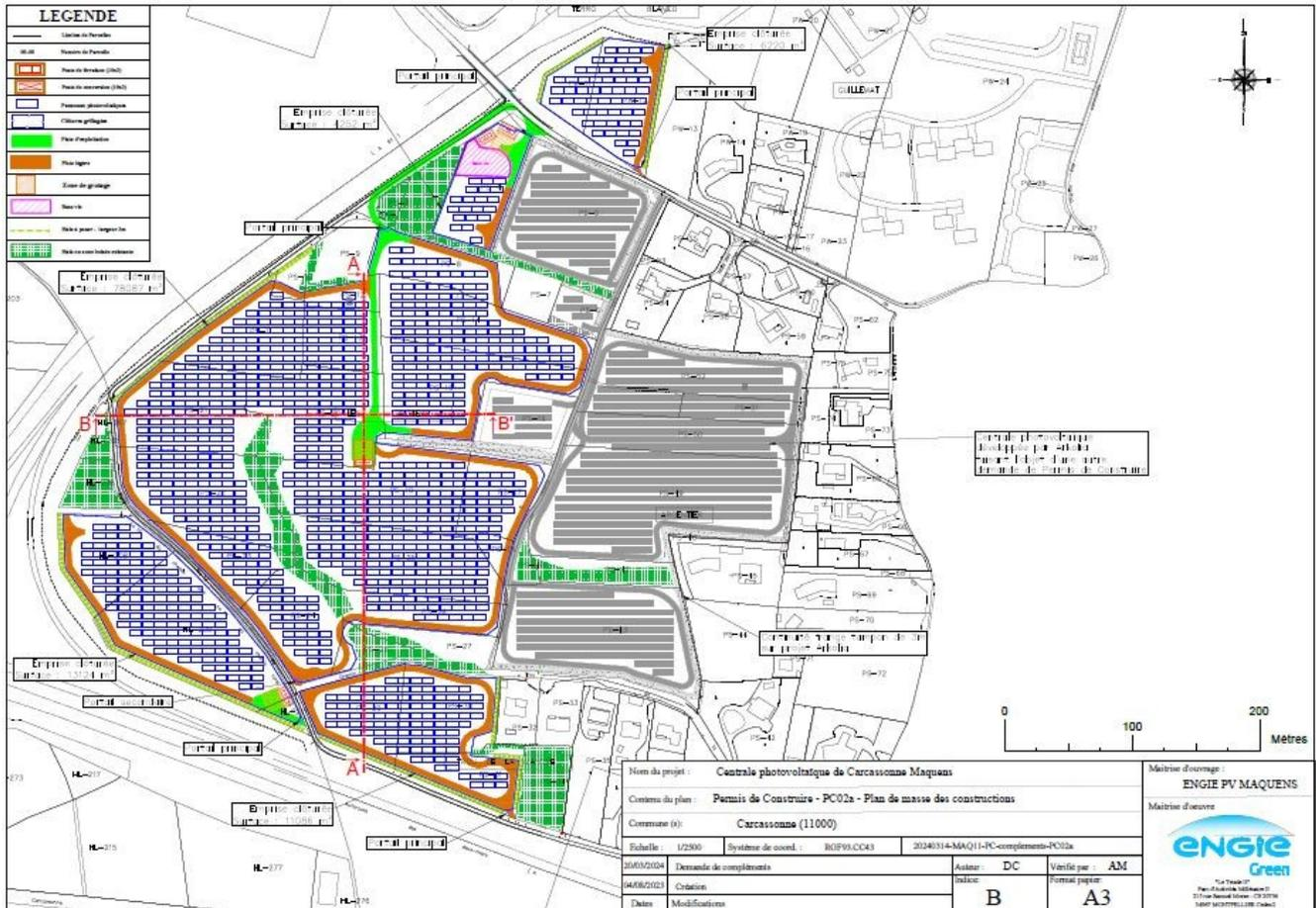
Figure 2: Plan de masse projet Maquens ouest
