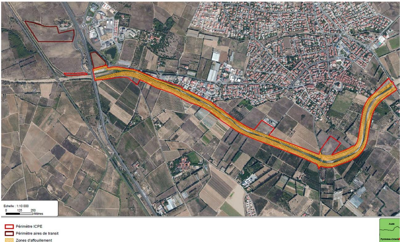
Figure n°5 : aires de transit et zone d'affouillement
