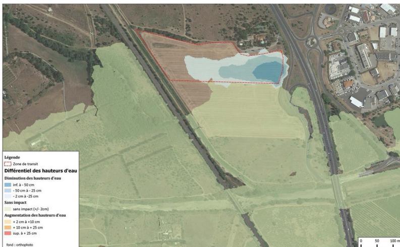
Figure n°9 : hauteurs d'eau sur l'aire de transit Mas de la Boneta avec stock de matériaux pour une crue de débit 520 m³/s
