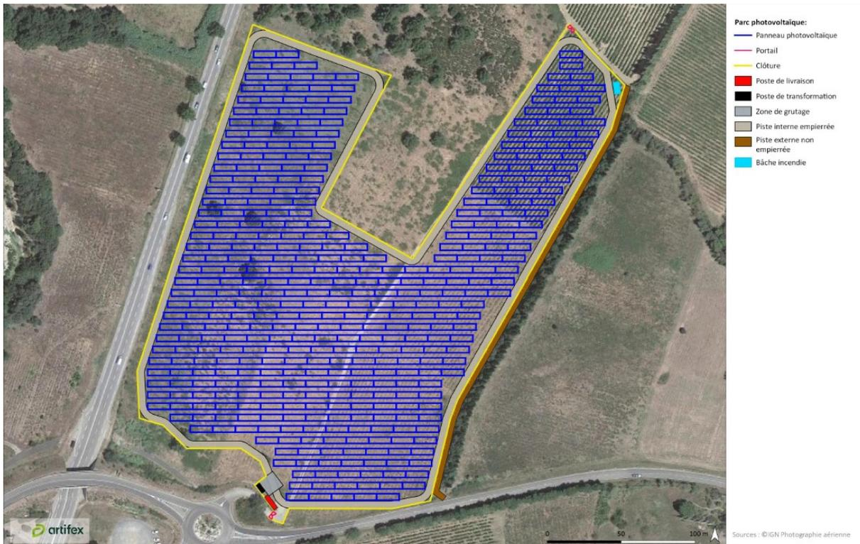
Figure 2 : plan de masse de la centrale – photo aérienne – réalisation ARTIFEX – (source : étude d'impact)
