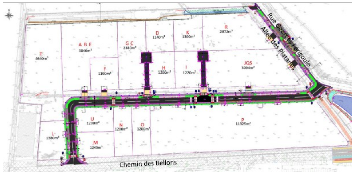
Figure 2: Principe d'aménagement du site figurant notamment les 16 lots cessibles et le système de voirie interne - Source : étude d'impact
