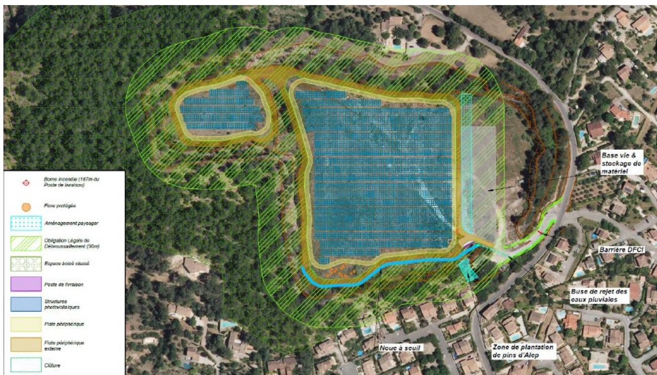
de garantir la sécurité des installations, une clôture grillagée d'une hauteur de 2 m est disposée sur le pourtour du site. Le projet nécessite la mise en œuvre d'obligations légales de débroussaillage (OLD) autour du parc, sur une largeur de 50 m, dans le cadre de la lutte contre les risques d'incendies de forêt.
