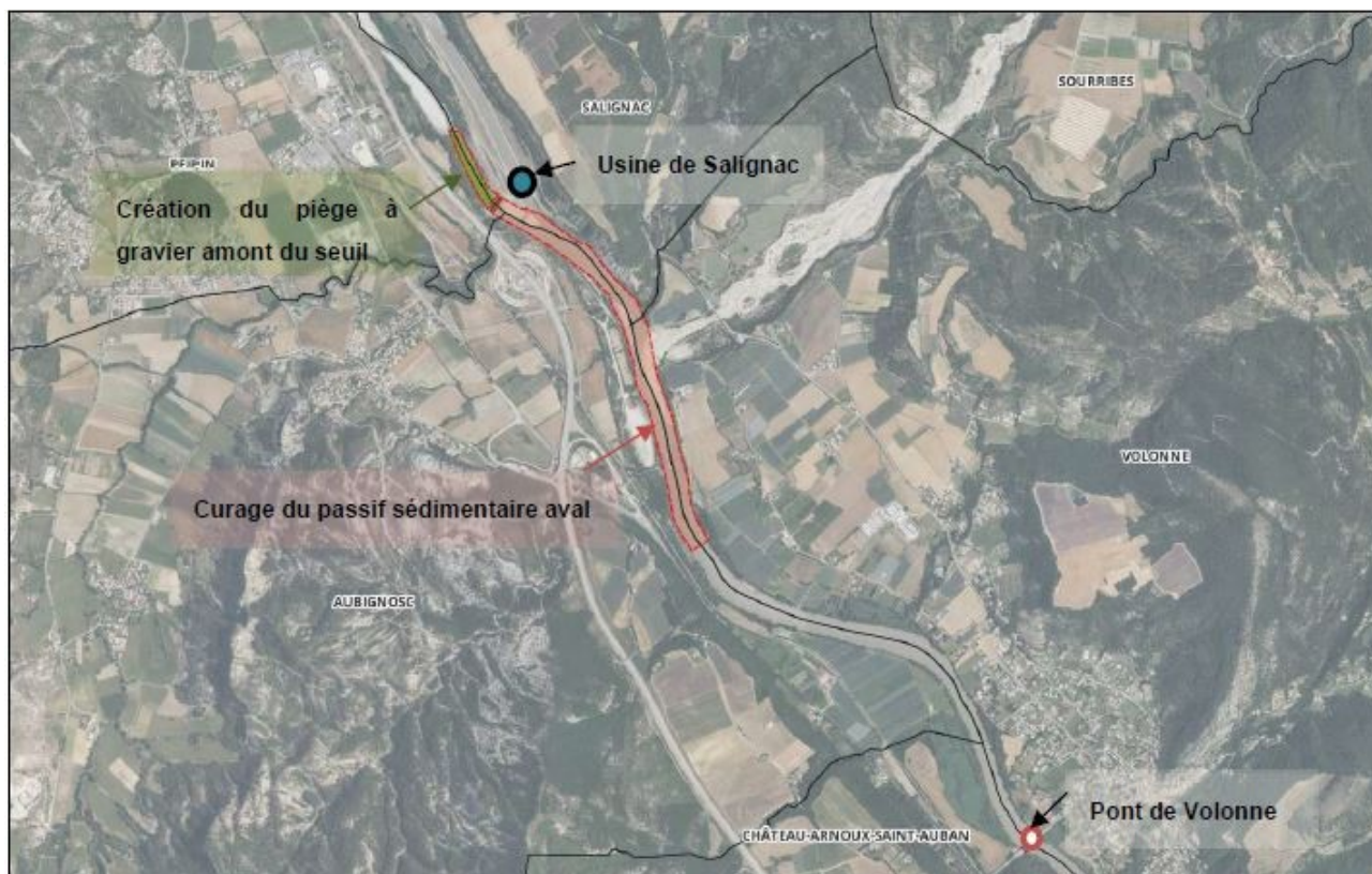
Figure 3: localisation des travaux envisagés. Source : étude d'impact.
