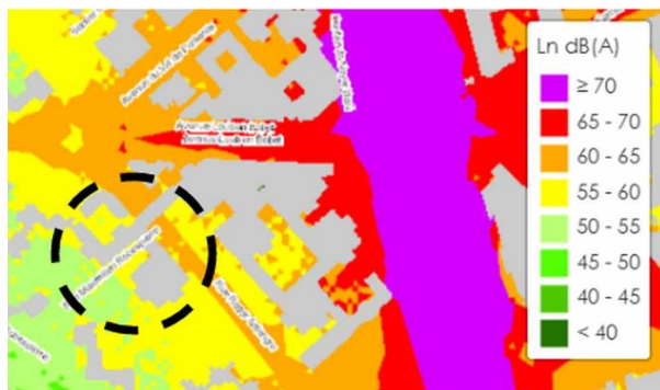
Figure 12 : Niveau de bruit routier de nuit supérieur à 55 dB (A) dans le secteur Écrins-Forez-Grisons - Source Bruitparif avec localisation du secteur (pointillé noir) MRAe
