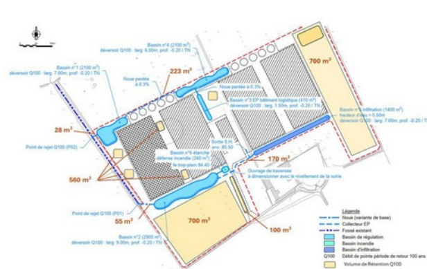
Figure 8 : Schéma du principe de gestion des pluies d'occurrences centennale (source : Pièce 2 - Notice descriptive du projet, p.29)
