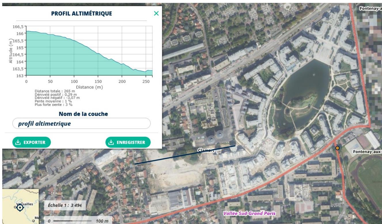
Illustration 14: profil altimétrique ouest-est montrant une altimétrie plus élevée de la ZAC Panorama 2 au regard de la Zac voisine déjà largement réalisée.
