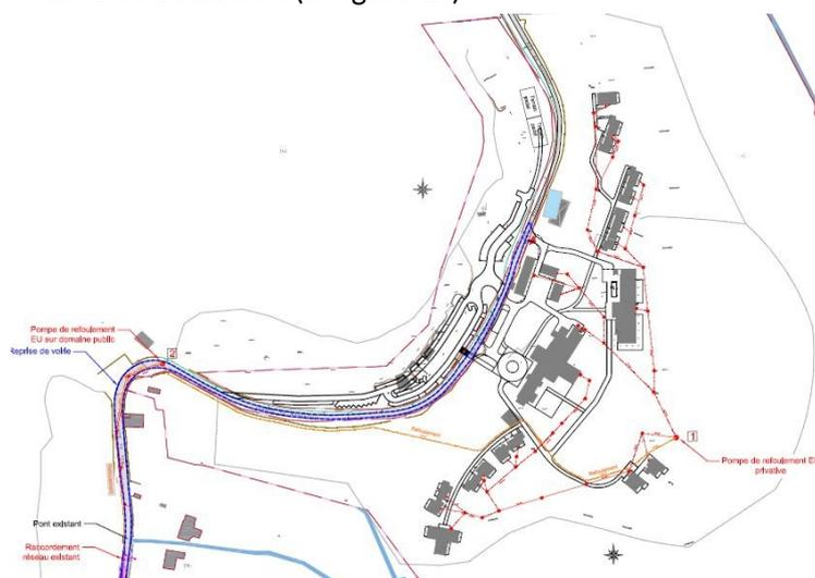
Figure 18 : Schéma de la proposition de raccordement du site au réseau d'assainissement public (source : note technique sur l'impact du raccordement du Domaine du Sausseron sur le réseau du Siarp et du Sicteu, p. 8)
