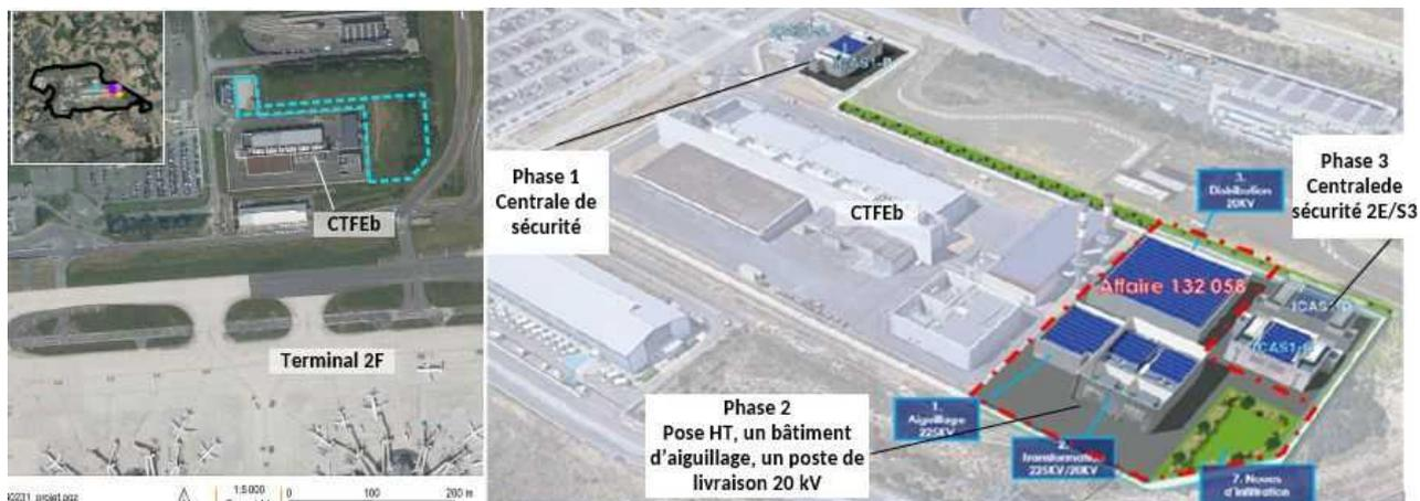
Illustration 4- À gauche, emplacement des installations électriques (pointillés bleus), et localisation sur la plateforme aéroportuaire (point bleu dans l'encart en haut à gauche). À droite, les phases chantier sont ajoutées à l'illustration (p. 27, modifié par la MRAe)
