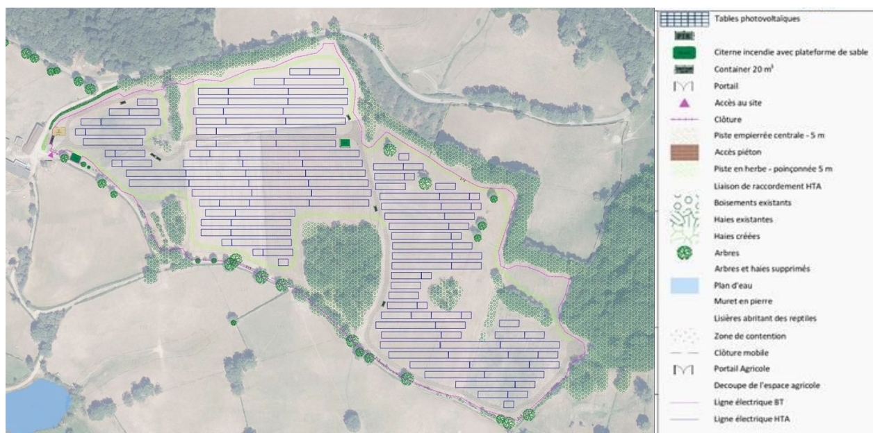
Figure 2: Plan d'implantation des installations du projet (source : étude d'impact)
