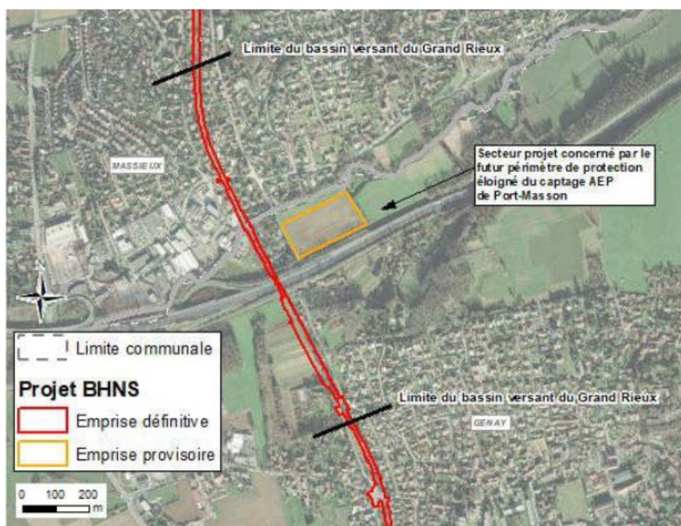
Figure 3: Limite du bassin versant du grand Rieu correspondant après révision au périmètre de protection éloigné du captage de Port Masson - Source : dossier
