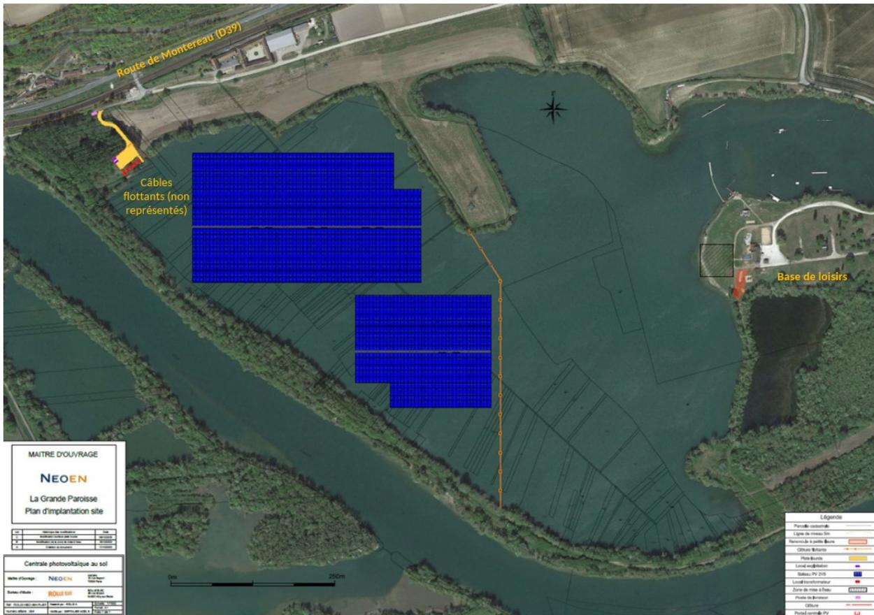
**Illustration 2- Projet d'implantation.** Les panneaux photovoltaïques sont visibles sur la partie ouest, séparés de la partie utilisée par la base de loisirs par une ligne de flotteurs en orange sur le plan. La partie technique, la piste et le poste de livraison sont visibles au nord-ouest, la clôture ne figure pas sur ce plan (p. 23)
