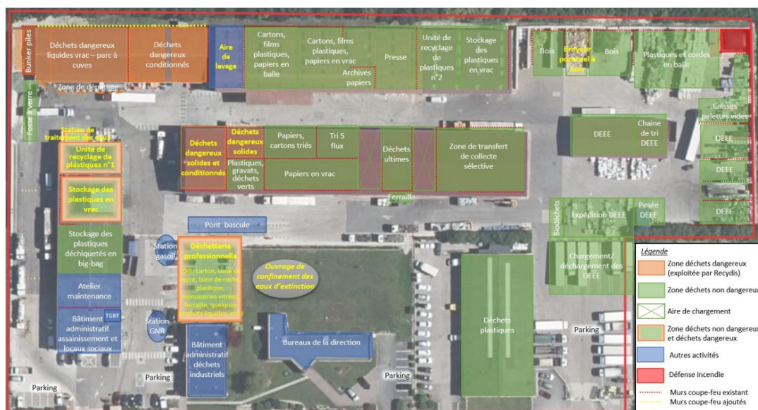
Figure 2: Implantation du site (les éléments en jaune représentent les installations qui font l'objet d'une modification)
